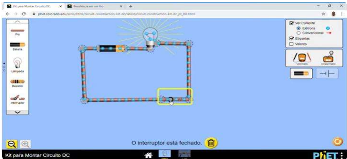
Print do Simulador Phet Colorado - Circuito elétrico simples DC
